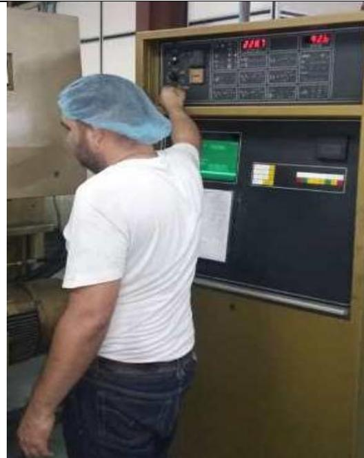
Imagen 27. Prueba del montaje y el ajuste del molde en máquina.
