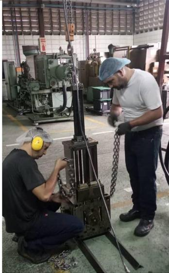
Imagen 17. El Aprendiz realizando maniobra de elevación con puente grúa.
