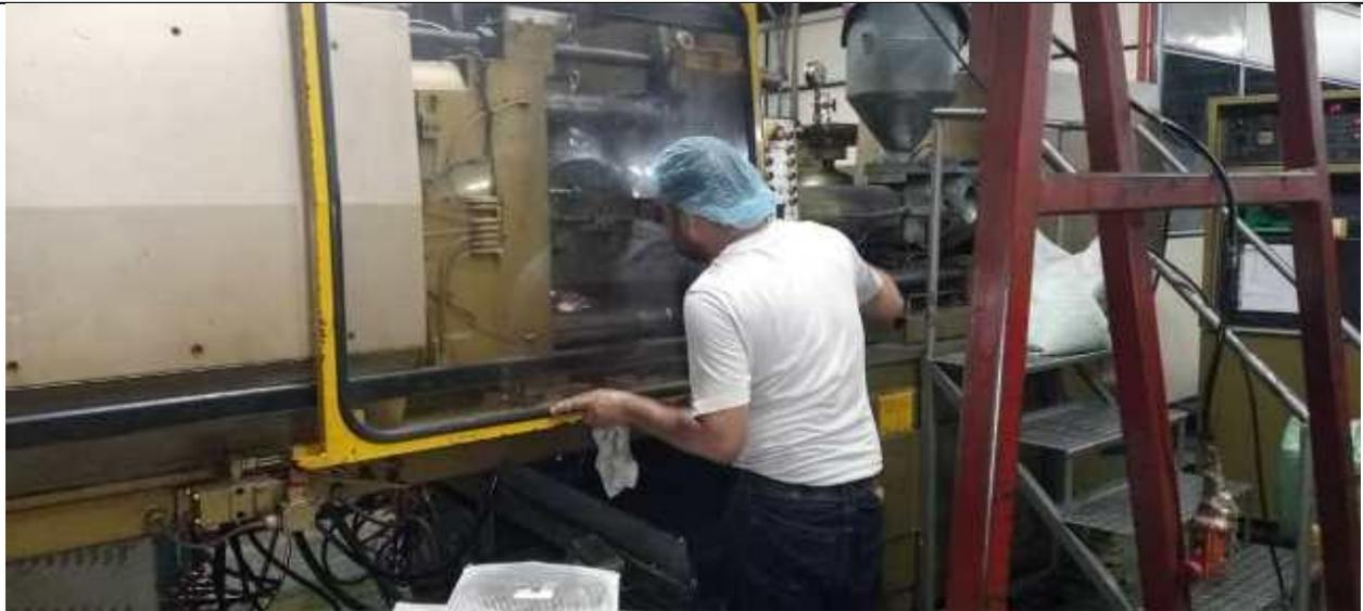
Imagen 23. Conexión de sistema de refrigeración-aterperador del molde.
