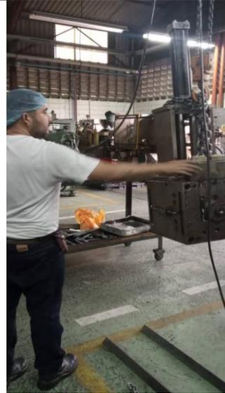
Imagen 18. Movilización de molde con puente grúa.
