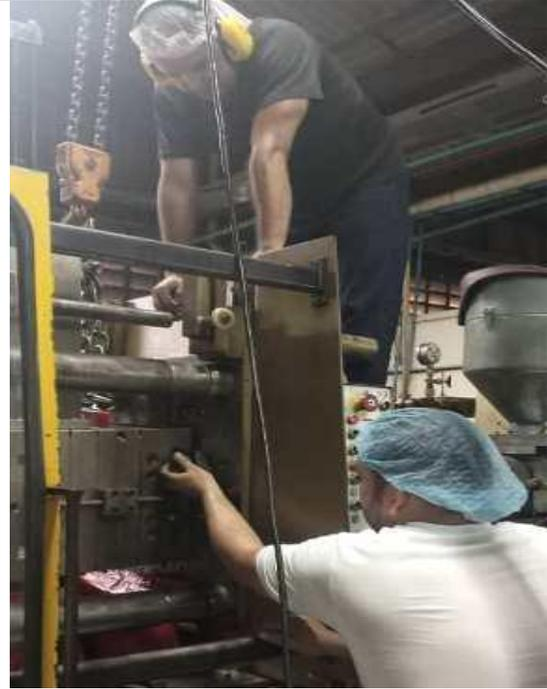
Imagen 22. Primeros movimientos de maquina con el molde ya en posición.
