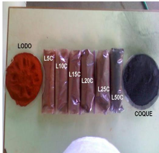
**Gráfico 9. Polvos de lodo rojo mezclados en proporciones de 5, 10, 15, 20, 25 y 50% en peso de coque. Lodo Rojo y Coque de Petróleo Pulverizados por L. Gómez**
