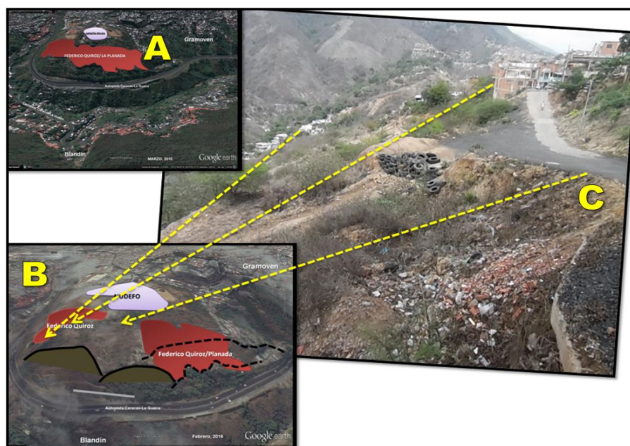
Gráfico 17. Vista comparada del sector Federico Quiroz (FQ), Catia, Parroquia Sucre, Distrito Capital, antes de evento (“A”-rojo) con respecto a la mancha urbana actual (“B”), fragmentada en dos sectores (FQ y La Planada) En el Centro, vista de la vialidad colapsada en 2010 y rehabilitada posterior al evento (“C”). Nótese la pérdida de viviendas en el centro de la mancha urbana. Imagen de Google Earth, 2010 y 2016. Marcano, abril de 2016.
