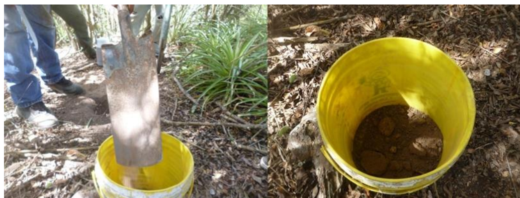
Figura 5. Extracción y mezcla de las submuestras.
