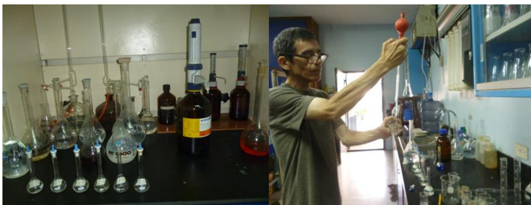
Figura 15. Medición de materia orgánica en las muestras de suelo.
