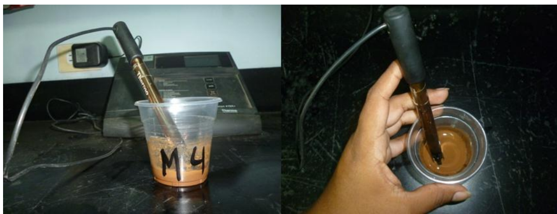
Figura 14. Medición de pH en agua de las muestras de suelo.
