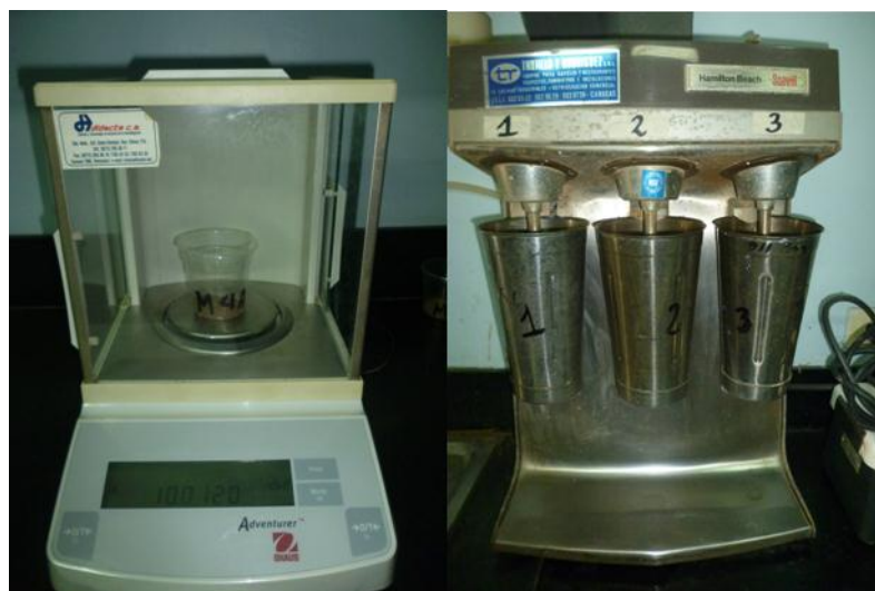
Figura 12. Pesaje de la muestra y mezcla en la batidora.
