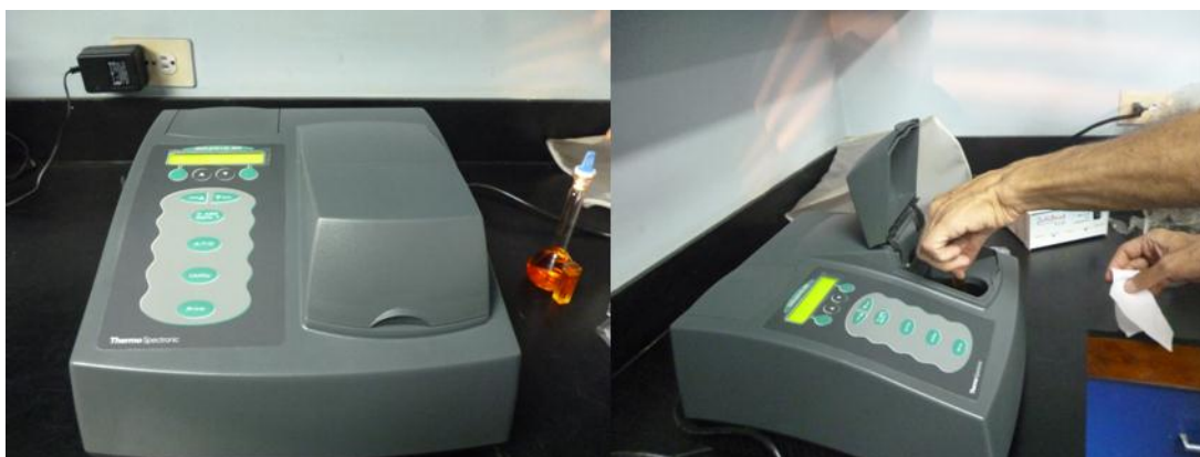
Figura 16. Medición de materia orgánica en en espectrofotómetro UV-Visible.
