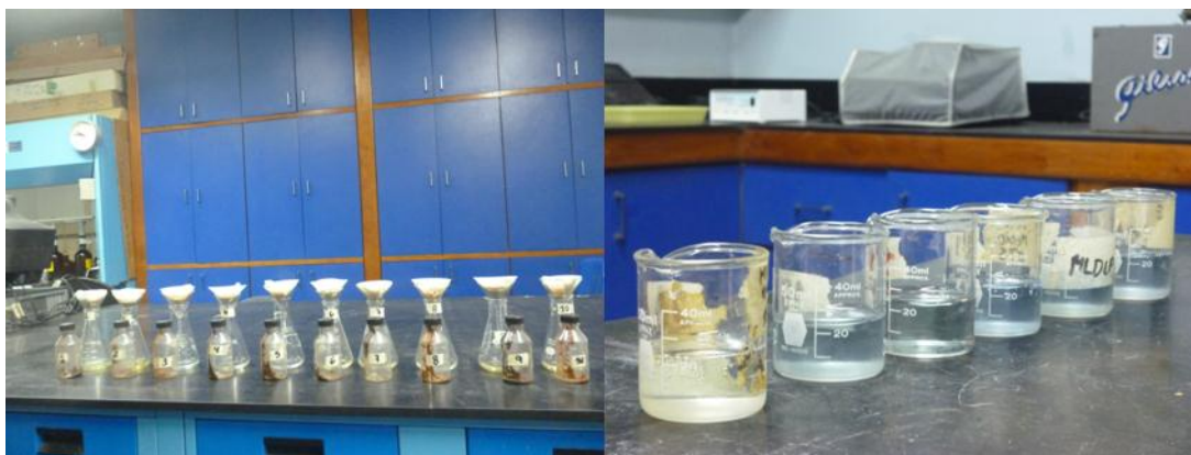
Figura 18. Medición de fosforo método de olsen (1964).
