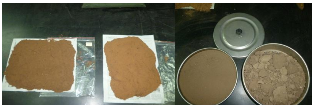
Figura 8. Muestras de suelo secas y separadas con el tamiz N°80.
