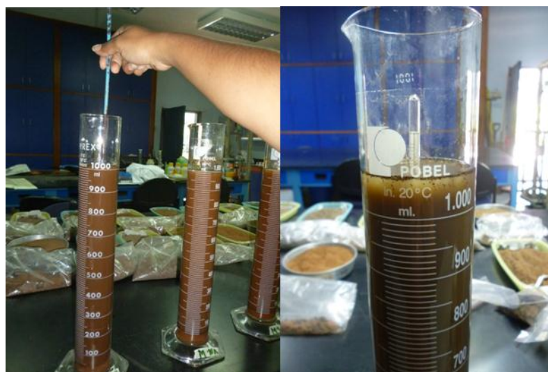
Figura 13. Agitación de la suspensión. Medición con el hidrómetro.
