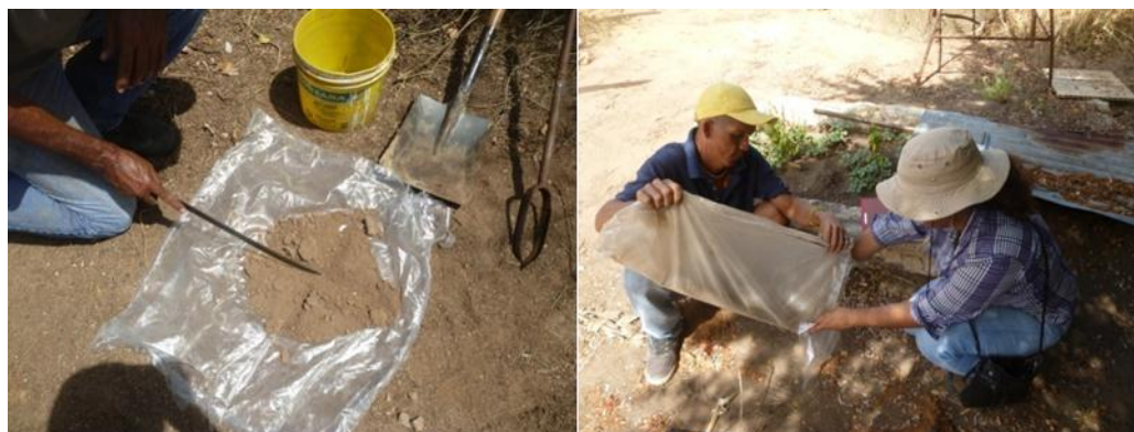
Figura 6. Método del cuarteo para homogenizar la muestra compuesta.
